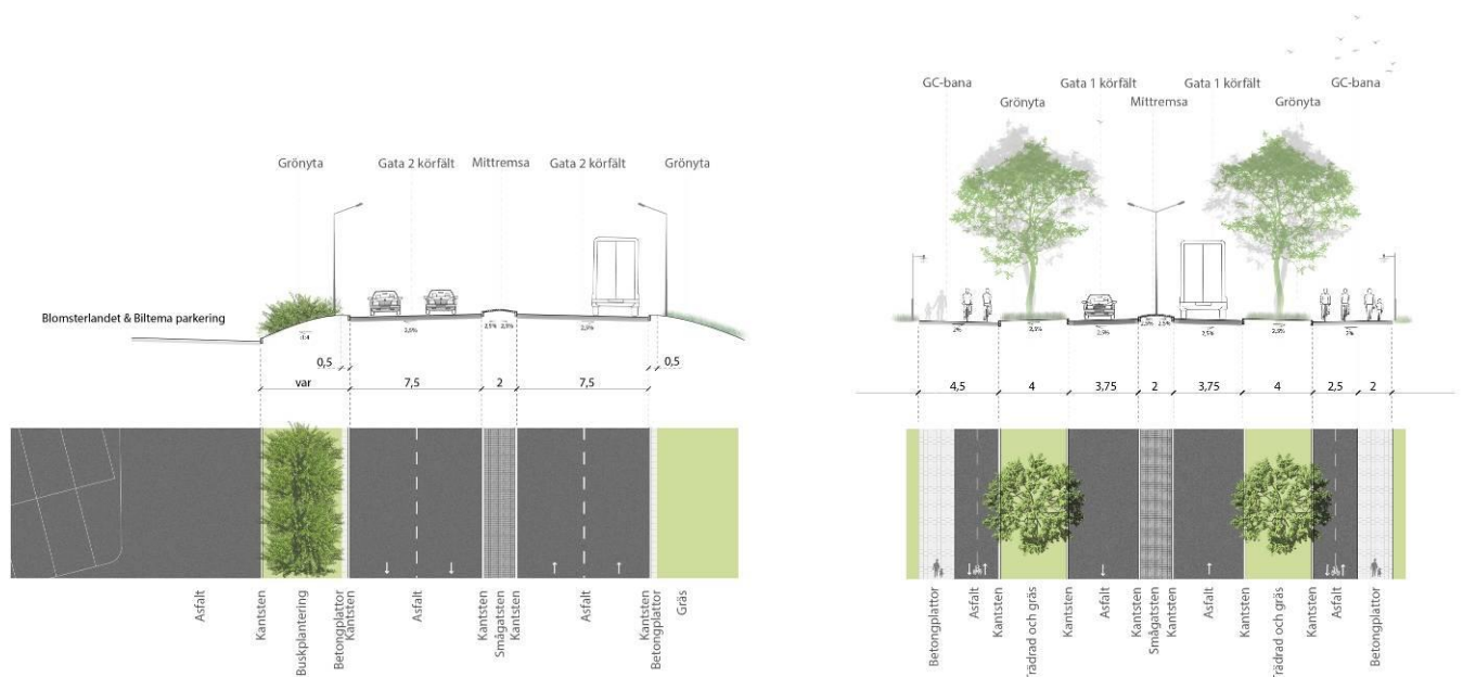
Sektion B-B och C-C (Se planillustration ovan) . Sektion för nya Kvilleleden, sett mot väster i avfart från Lundbyleden / Kvillemotet. Sektion för Mineleundsgatan i Kvilleledensförlängning, sett mot väster. Bild Trafikkontoret/Cowi.
