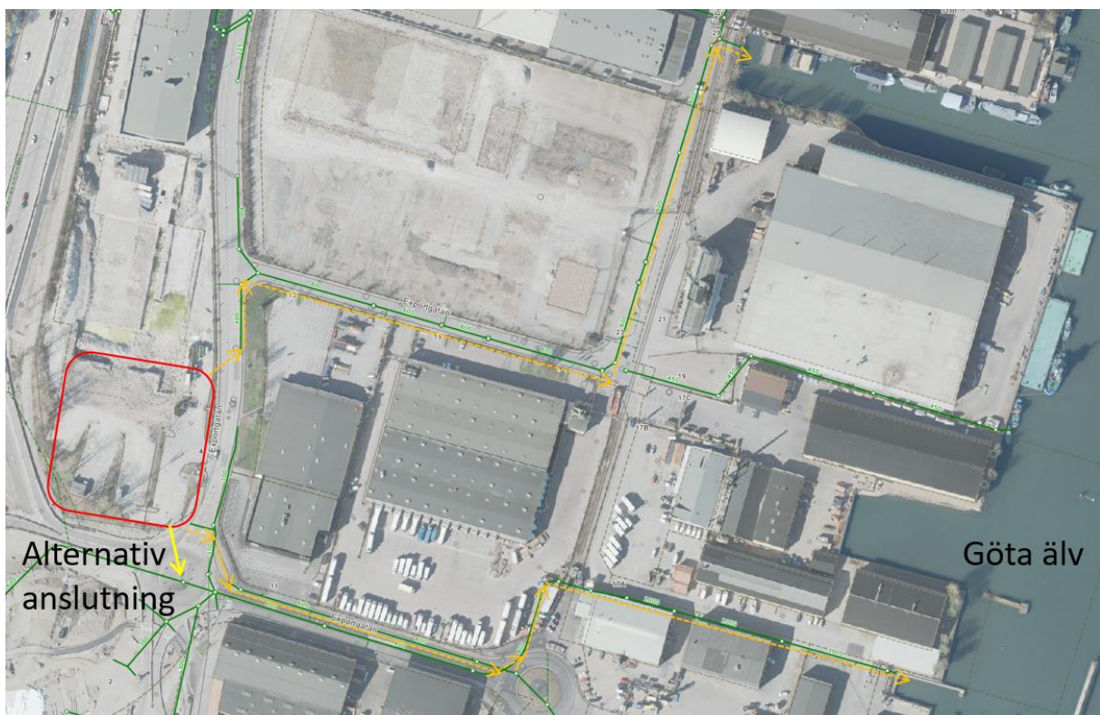
Figur 6. Karta över planområden (röd) och dagvattenförande separat ledningssystem (grön). Orange streckad linje visar möjliga avledningar från planområdet, en åt nordost och en åt sydost. Båda leder till Göta älv. Gul pil visar alternativ anslutning åt syd [VA-banken, 2021]
