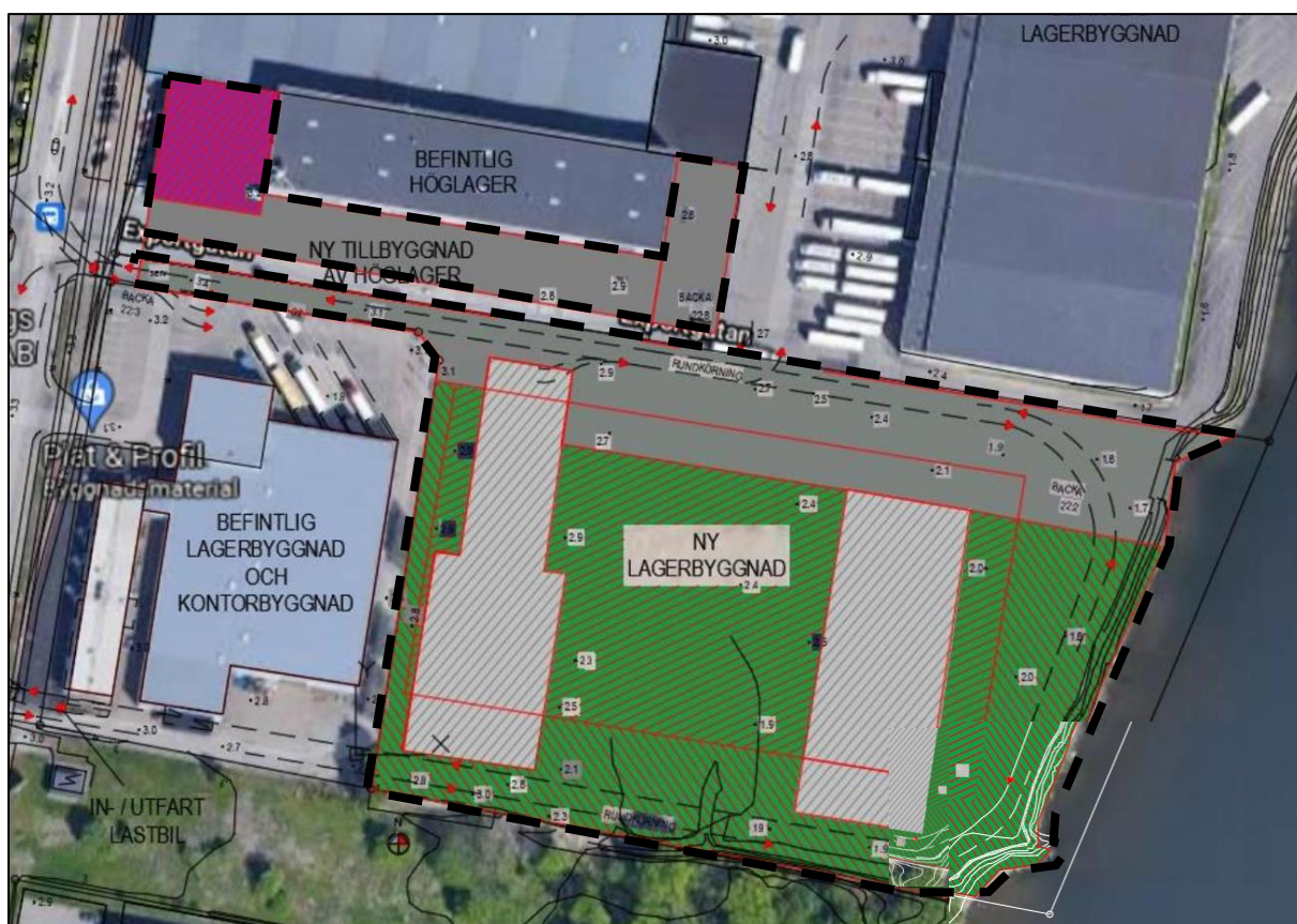
Figur 16. Markanvändning före utbyggnad, Mörkgrå yta motsvarar asfaltsyta, grön yta motsvarar grusyta, ljus grå yta motsvarar betong och rosa yta motsvarar takyta. Svart streckad linje visar avgränsningen av norra respektive södra delområdet.
