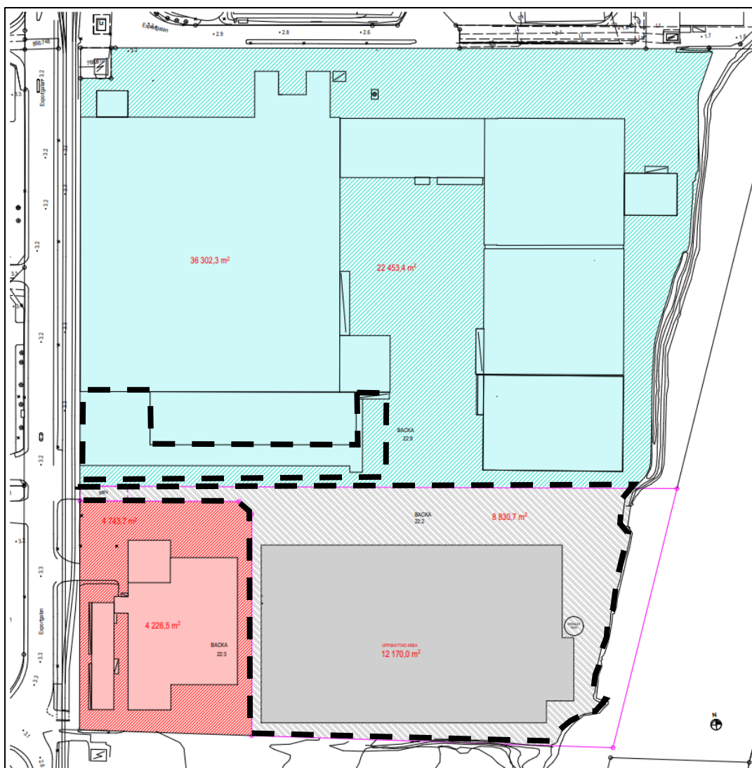
Figur 17. Markanvändning efter utbyggnad (Dagab, 2021). För norra delområdet visar ljus turkos att det är takyta och mörkare turkos motsvarar asfaltsyta. I södra delområdet motsvarar randig grå asfaltsyta och mörkare grå motsvarar takyta. Svart streckad linje visar avgränsningen av norra respektive södra delområdet.
