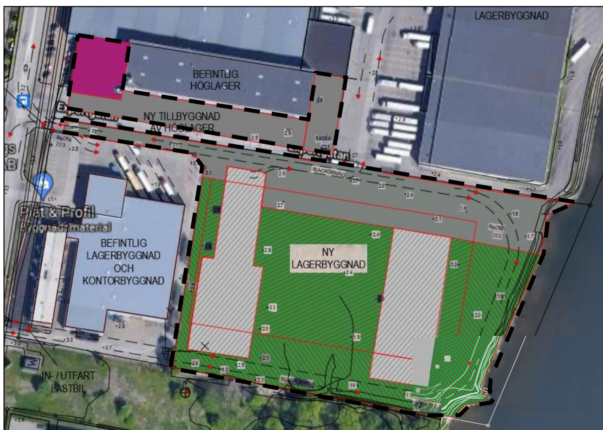
Figur 19. Markanvändning före utbyggnad, Mörkgrå yta motsvarar asfaltsyta, grön yta motsvarar grusyta, ljus grå yta motsvarar betong och rosa yta motsvarar takyta. Svart streckad linje visar avgränsningen av norra respektive södra delområdet.
