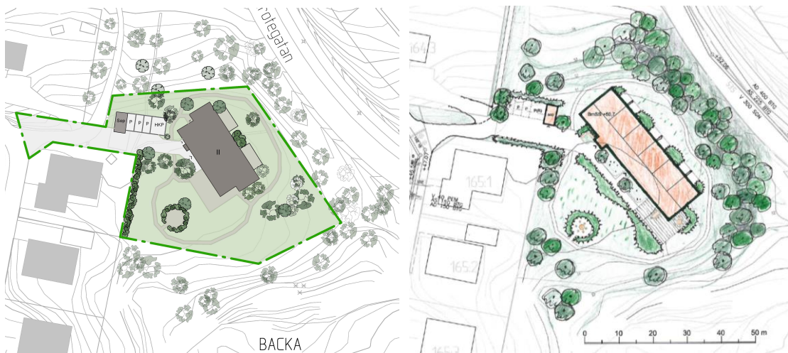
Figur 27, Skiss alternativ med åtta lägenheter i två plan. Illustration: Norconsult. Figur 28, Skiss alternativ med sex lägenheter i ett plan. Illustration: Norconsult
