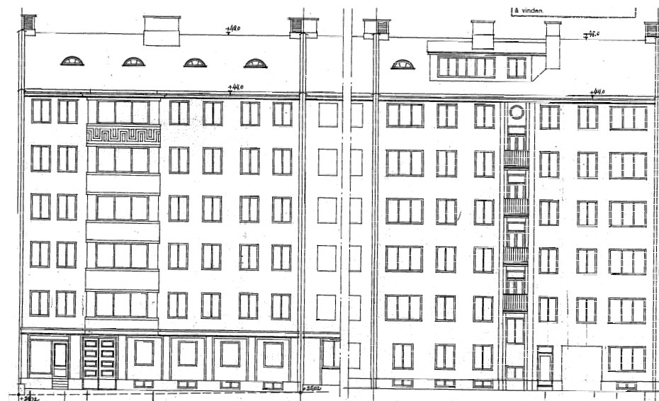
Originalritning från 1931, Jättegrytsgatan 3A (kv Midasörat), gatu- och gårdsfasad. Här fanns ett antal glest placerade och lunettformade kupor mot gatan samt en större takkupa mot gården som släppte in dagsljus i trapphus och tvättstuga. Källa: SBK.
