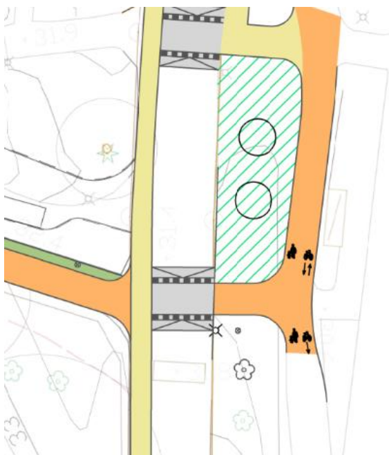
Figur 11. Gång- och cykelvägens anslutning mot Lilla Danska vägen samt gång- och cykelbana längs Danska vägen.
