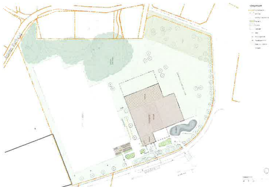
Figur 16 - Föreslagen byggnad och utformning av angöringsytor och fria ytor.
