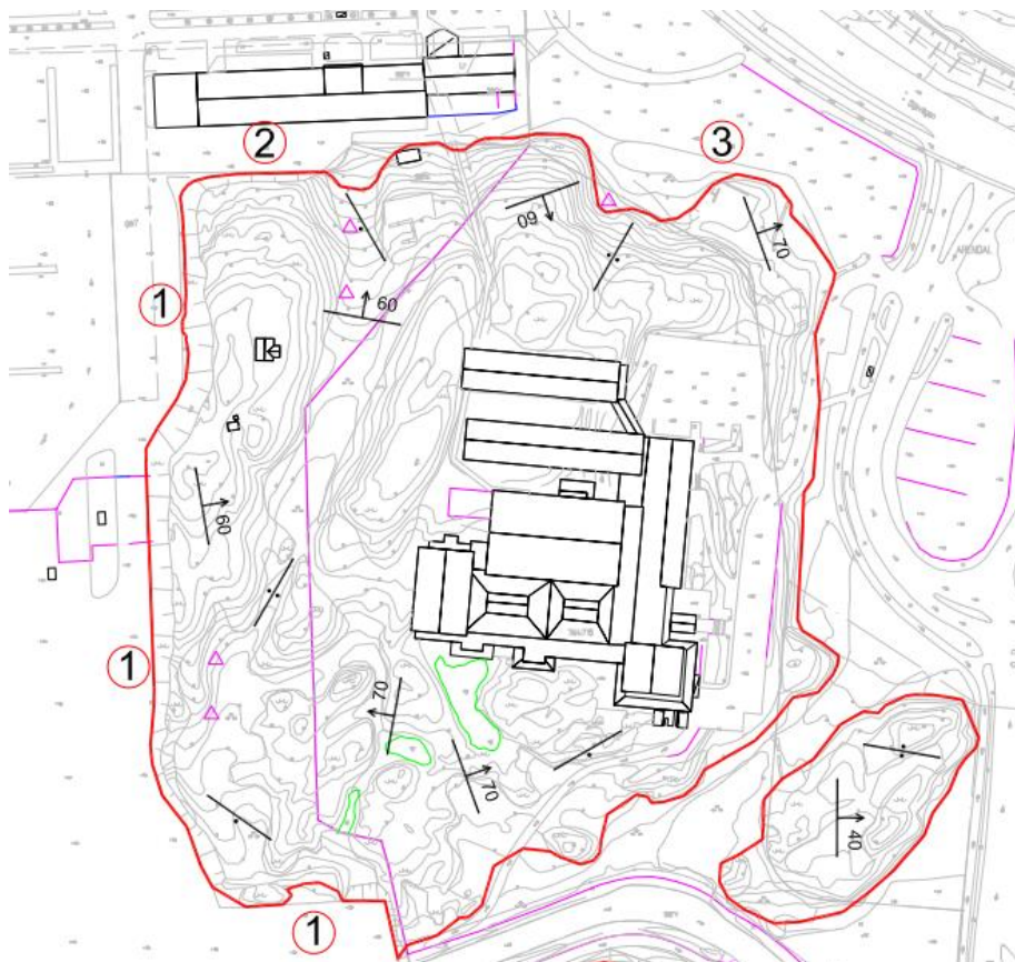
Figur 19 Planritning från bergteknisk utredning (Bergab, 2012-02-22) med markerade slänter som ingår i kontrollprogram.
