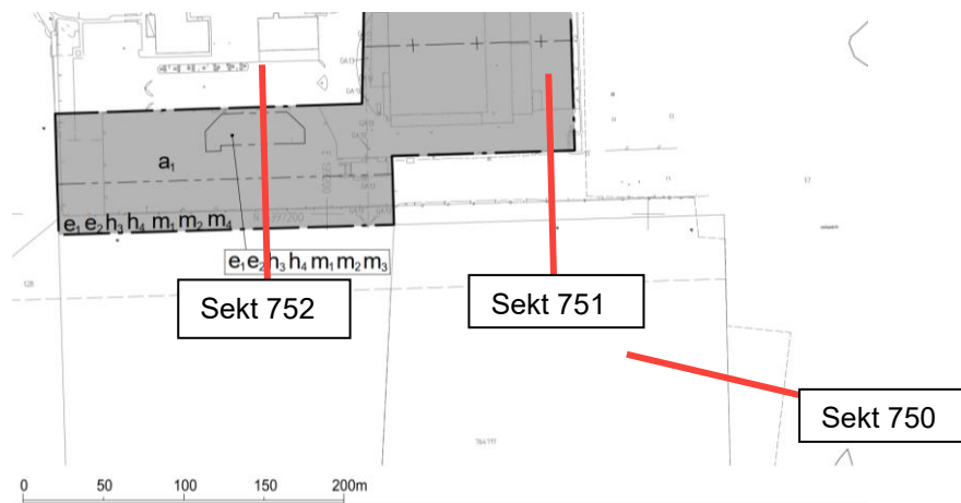
Figur 23: Beräkningssektioner för att representera stabilitetsförhållandena inom respektive kajplats.
