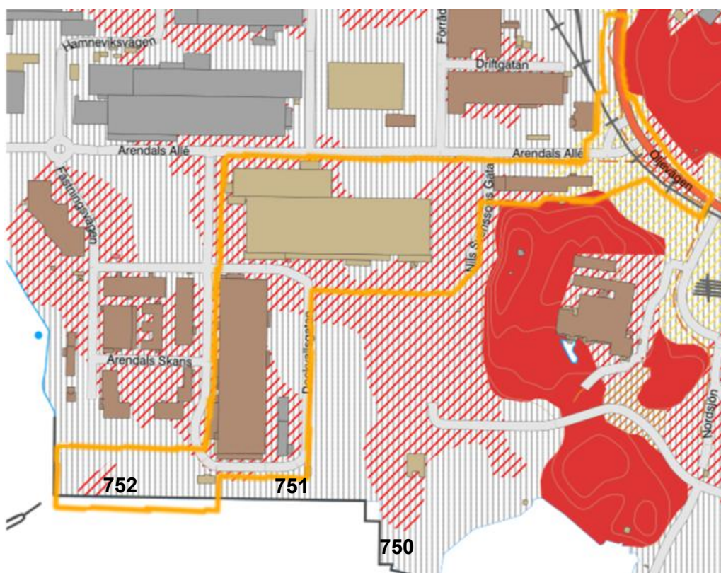
Figur 8. Jordartskartan visar att terminalområdet utgörs av fyllning (vitskrifferade områden), fyllning ovan berg (rödskrifferade områden) och fyllning ovan lera (gulskrifferade områden) (Källa: SGU, 2023-01-27). Ungefärlig avgränsning av planområdet visas med orange linje.
