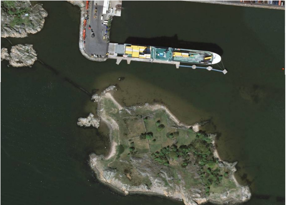
Figur 2. Befintligt läge norr om Stora Aspholmen. På den för vågor skyddade norra sidan av Stora Aspholmens har sand avsatts under åren. Motsvarande avsättningar finns inte på den för vågor mer utsatta sydsidan.
