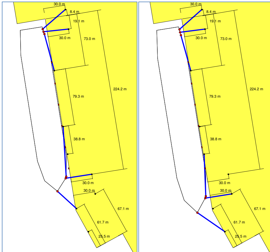
Figur 4. Pollarplacering och förtöjningsarrangemang för de två testade fartygsstorlekarna. 230 m fartyget till vänster och 260 m fartyget till höger.
