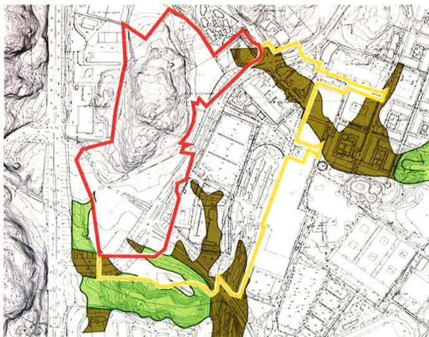
Utfyllnadsområden i ursprungliga raviner (ur geotekniskt PM)
