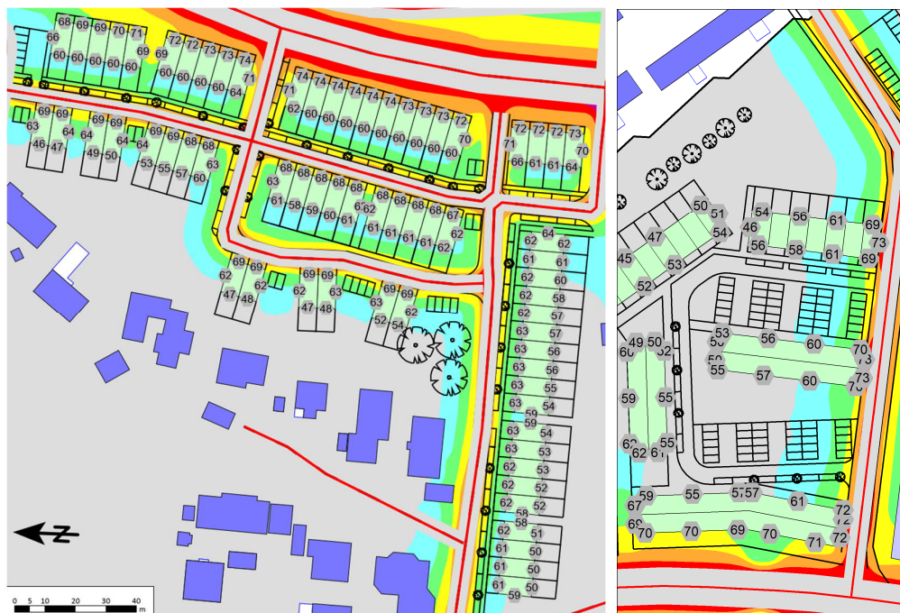
Figur 8 och 9. Maximal ljudnivå beräknad utifrån femte högsta passagen per timme (kl. 06–22). Ej tung trafik på Juteskärgsgatan.
