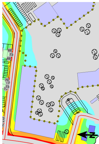
Figur 10 (Till vänster). Maximal ljudnivå beräknad utifrån femte högsta passagen per timme (kl. 06–22). Ej tung trafik på Juteskärgsgatan. Skolgården är markerad med prickar.
