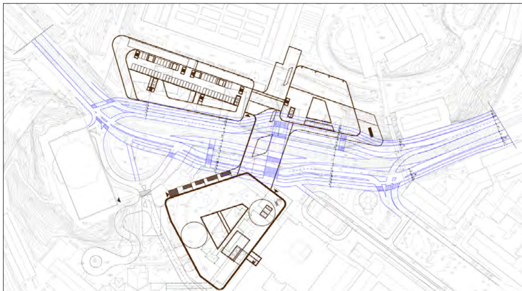
Figur 15 Principskiss över saxade hållplatslägen. (Skiss 2018-02-22).
