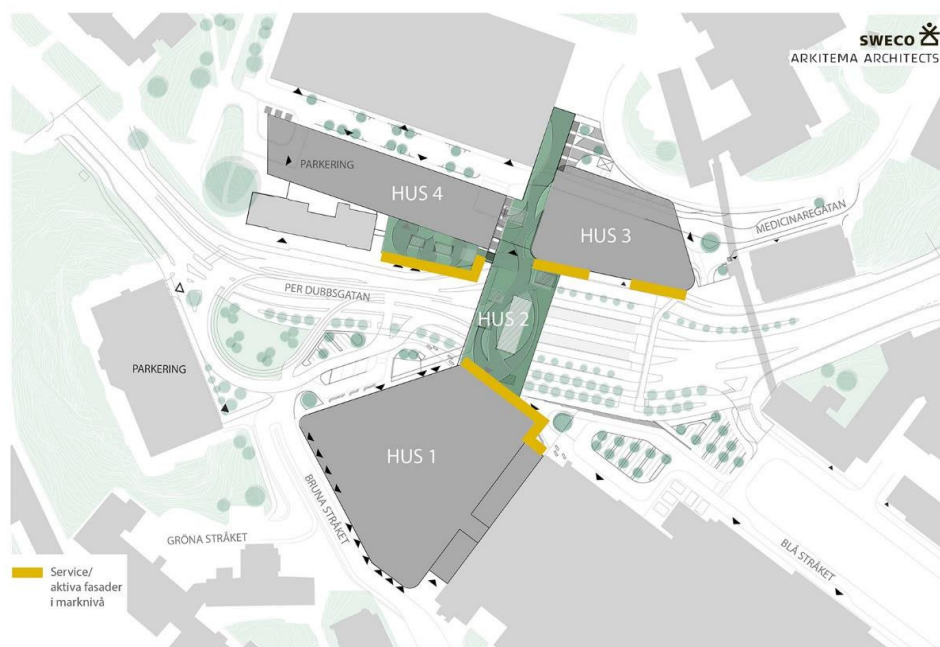
Figur 18 "Aktiva fasader" i marknivå för ökad trygghetskänsla och ett socialt liv i gatumiljön. Bild: Arkitema/Sweco
