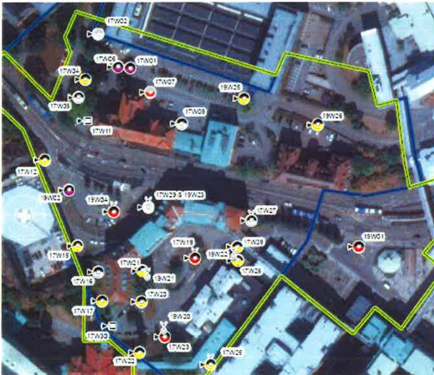
Figur 5. Kartan visar de provtagna punkterna inom planområdet. De punkter där sanering krävs innan byggnation får ske är markerade med rött och lila. I östra delen av planområdet saknas provtagningspunkter, av den anledningen visas ovan en inzoomad bild. Bild: WSP.
