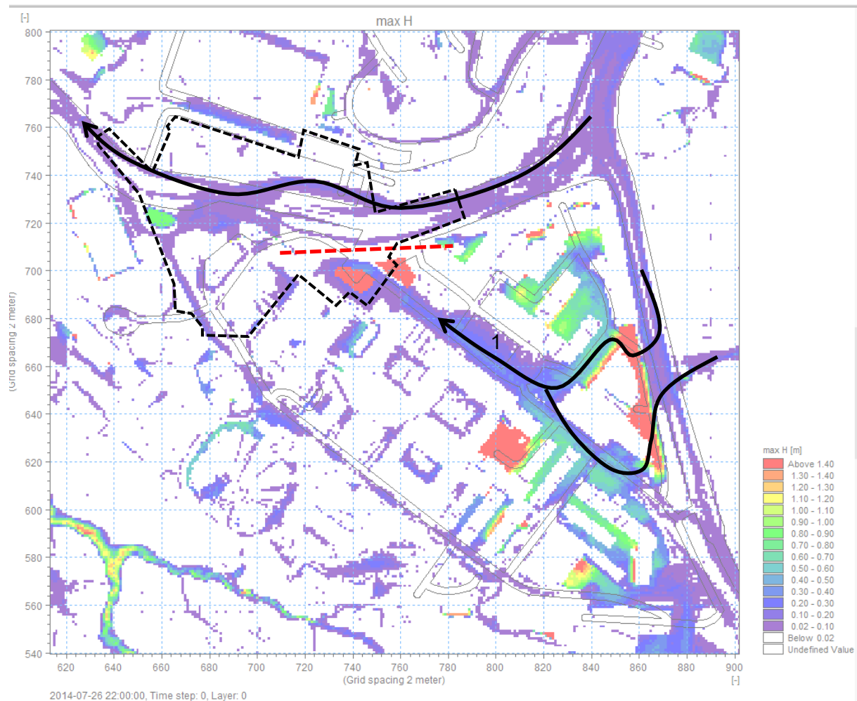
Figur 2 Maximalt översvämningsdjup över Sahlgrenska vid skyfall enligt Rambölls skyfallsmodellering av uppströms avrinningsområde (2019)
