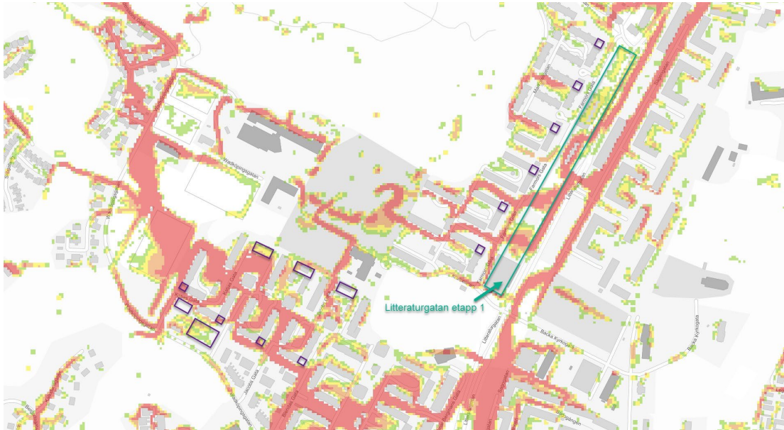
Figur 4: Ytvattenflöden, hela planområdet, vid ett klimatanpassat 100-årsregn. De lila figurerna föreställer förslaget på ny bebyggelse i området. Grön markering visar vart pågående projekt Litteraturgatan etapp 1 tar plats.
