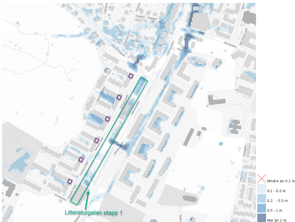
Figur 3: Vattennivåer vid ett klimatanpassat 100-årsregn vid Farmors Gata/Litteraturgatan. De lila figurerna föreställer förslaget på ny bebyggelse i området. Grön markering visar vart pågående projekt Litteraturgatan etapp 1 tar plats.
