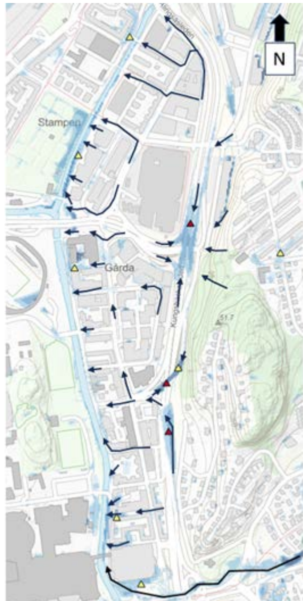
Befintliga förväntade vattenansamlingar vid ett skyfall samt skadad prioriterad väg och generella flödesriktningar.
