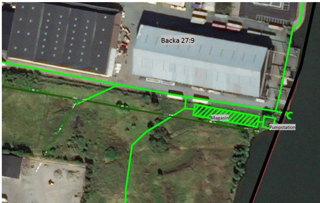
Figur 20. Placering av magasin samt pumpstation inom Exportgatans avrinningsområde.
