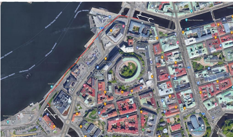
Figur 6. Konceptuell illustration av system med två skydds/slussportar (vitt) samt sträcka för kompletterande inströmningskydd (rött).
