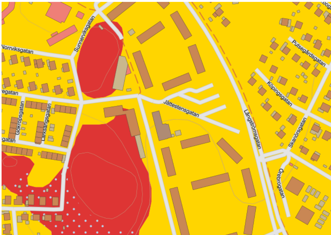
Figur 17. Karta: Utdrag ur SGU:s översiktliga jordartskartor. Gult är glacial lera och rött är urberg.
