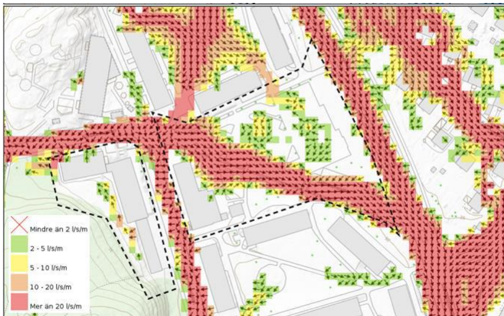
Figur 24. Karta: Skyfallsmodellering vid regn med 100 års återkomsttid. Röda markeringar och svarta markeringar visar östra och västra delen av planområdet där det samlas 850 m 3 respektive 200 m 3 .
