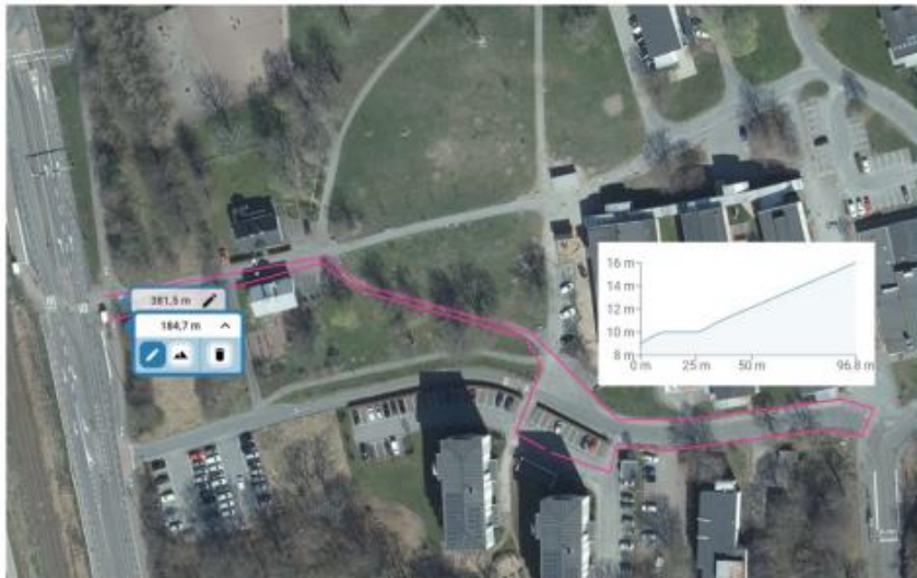
Figur 2: Att ta sig från fastigheten Backa 210:6 till den vänligaste busshållplatsen i närheten i enlighet med kommunens förslag skulle innebära en fördubbling av avståndet och en uppförbacke på närmare 7m med 7% lutning
