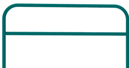
Figur 2- Cykelställ Sheffield från Falco (artikelnummer 02.102.000). Utrustningen är 1800 mm bred med en rördiameter på 42 mm. Utrustningen monteras så att den når en topphöjd av 700 mm över markytan, vilket är något lägre än standardhöjd för cykelställ. Färgen är inte beslutad.
