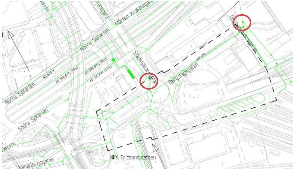
Figur 3. Befintliga dagvattenledningar (allmänna och privata); utsnitt ur bilaga till PM stationsområdena 2014-04-11 (Norconsult). Observera att planområdet ändrats något. Möjliga anslutningspunkter till befintligt dagvattennät är markerade med rött.
