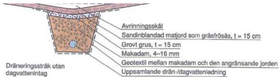
Figur 8. Skiss över stenkista av typen dikesmagasin (Svenskt Vatten P104).
