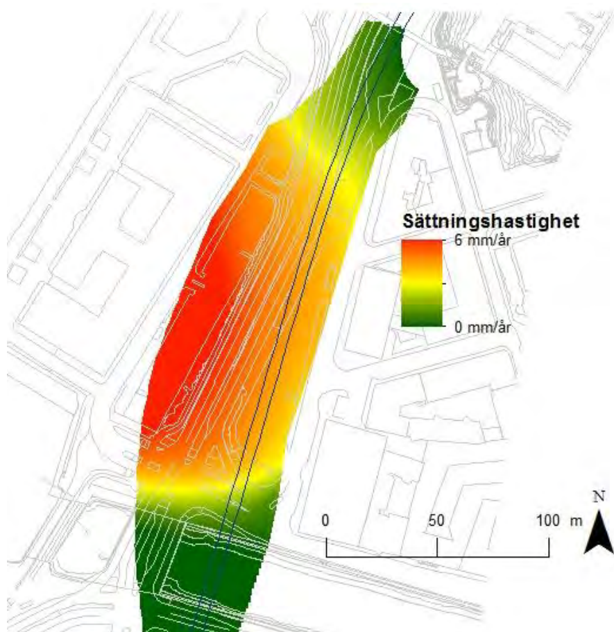
Figur 20 Pågående marksättningar inom området för Packhusplatsen.
