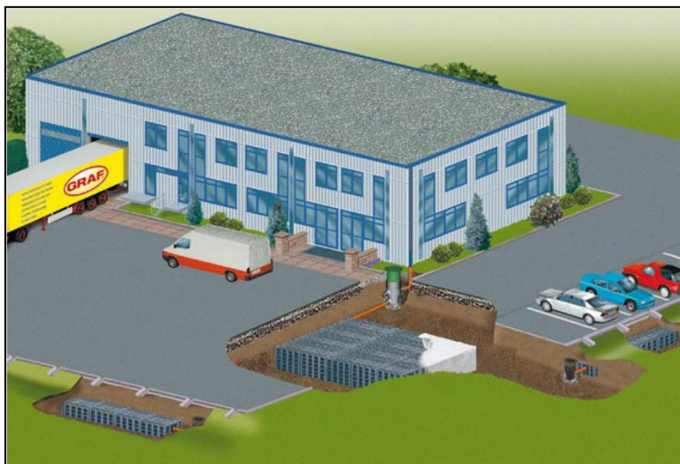
Figur 4. Exempel på utjämningsmagasin bestående av dagvattenkassetter (Uponor)
