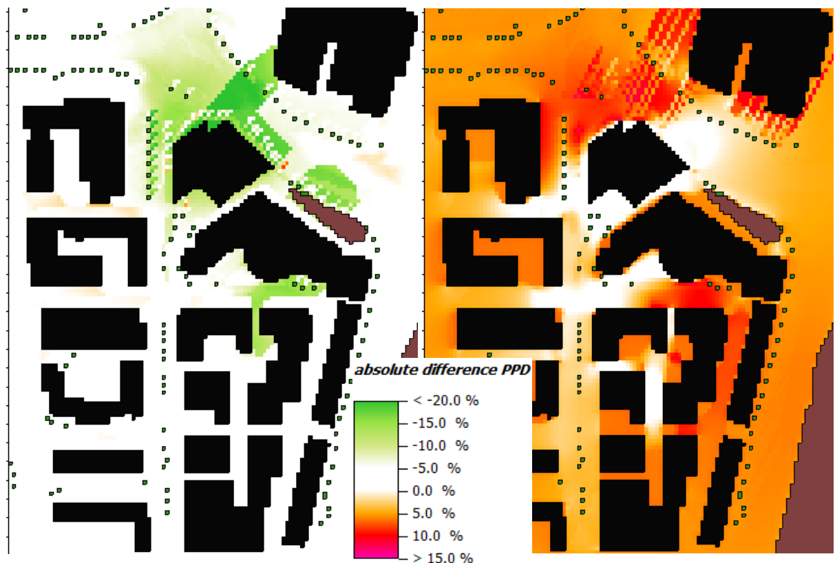
Figur 32: Jämförelse av termisk komfort kl 14 mellan planförslaget och existerande bebyggelse. T v sommar, t h vinter. Grönt betyder bättre komfort, rött är sämre.
