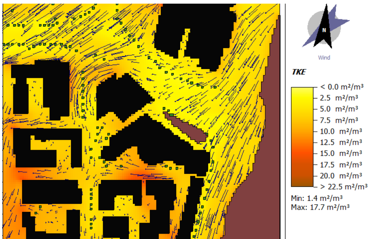
Figur 27: Vindförhållanden 1,5 m över mark kl 14 i januari; Medelvinden representeras av pilarna och vindstyrkorna ligger på max 4 m/s. Färgskalan anger turbulens (TKE-värde).
